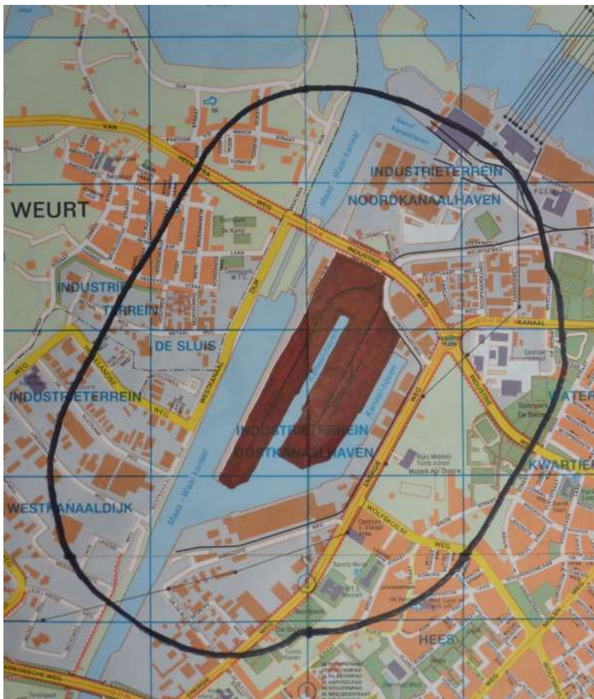
Bijlage 1. 700 meter richtafstand VNG van bedrijventerrein-3 (milieucategorie t/m 5.2) in relatie tot Weurt en Hees
