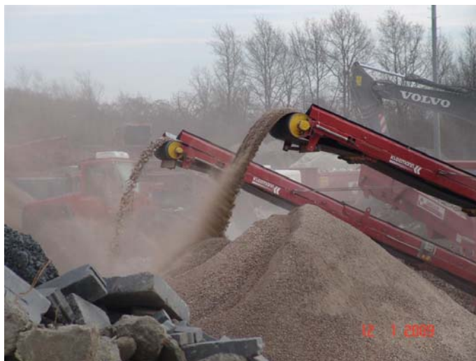
Geen afschermkappen voorgeschreven (ontbrekende BBT)
