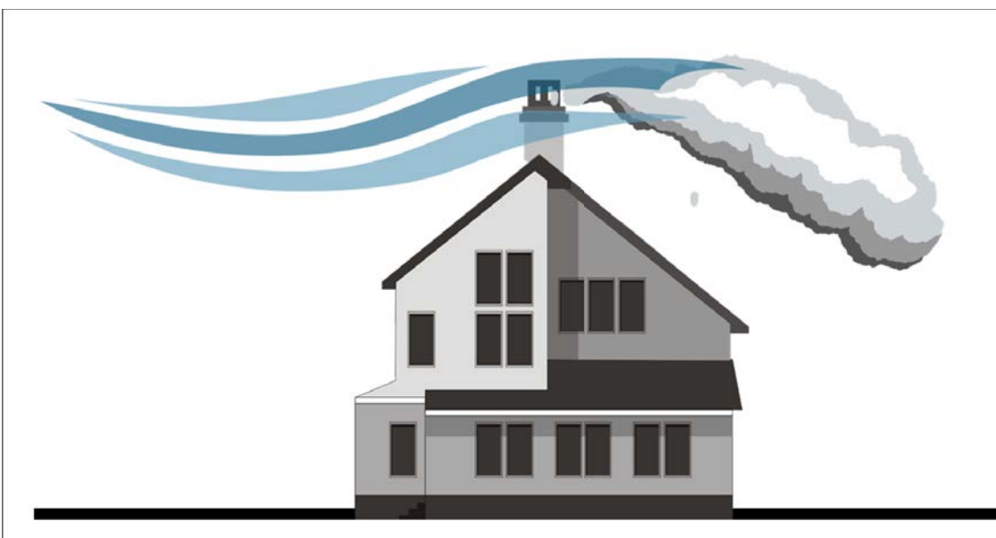
Afbeelding 8.13: Downwash effect bij rookgasafvoer boven nokhoogte
