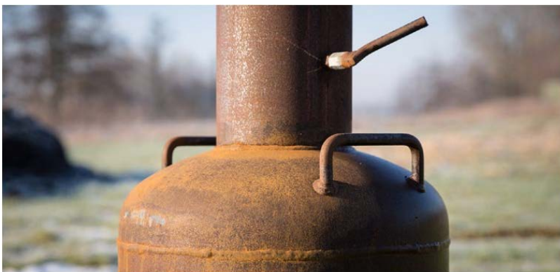
Afbeelding 4.1: Smoorklep in een terraskachel
