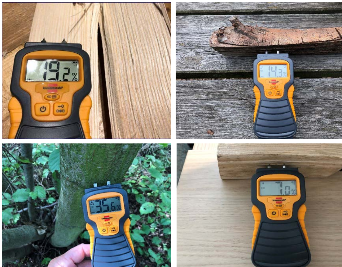
Afbeelding 3.2: Houtvochtmeter met op de display het watergehalte op volumebasis. Linksboven hardhout dat een dag eerder bij een bouwmarkt is gekocht. Rechtsboven essenhout dat drie jaar in de buitenlucht heeft gedroogd. Linksonder levend beukenhout dat maximaal vocht bevat en rechtsonder extreem droog hardhout dat na de normale droogtijd nog eens circa één jaar binnenshuis is gedroogd.
