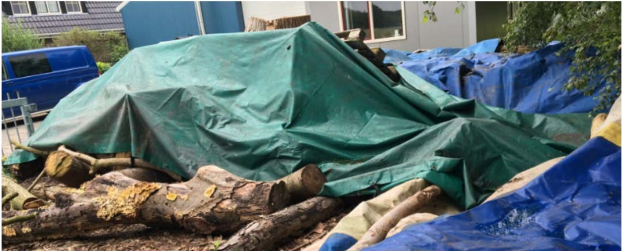
Afbeelding 3.4: Voorbeeld van slechte vochtafvoer door afdekking met zeil.
