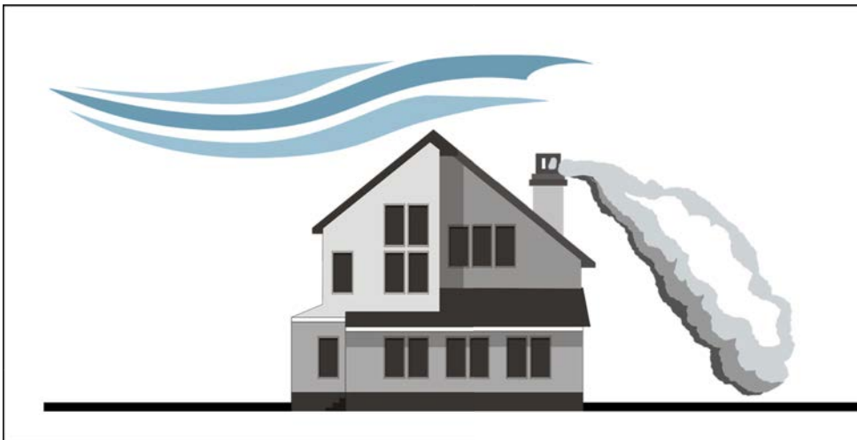
Afbeelding 8.12: Rookgasafvoer onder nokhoogte waardoor het down wash effect optreedt.
