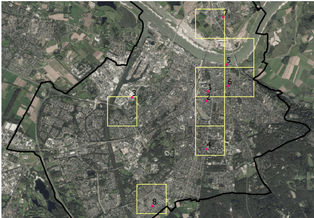
Figuur 1 Ligging van de toetspunten uit tabel 1 met gemeentegrens (zwarte lijn) en GCN kilometerblokken van het rijkdriehoekscoördinatenstelsel (geel) waarin deze toetspunten gelegen zijn.
